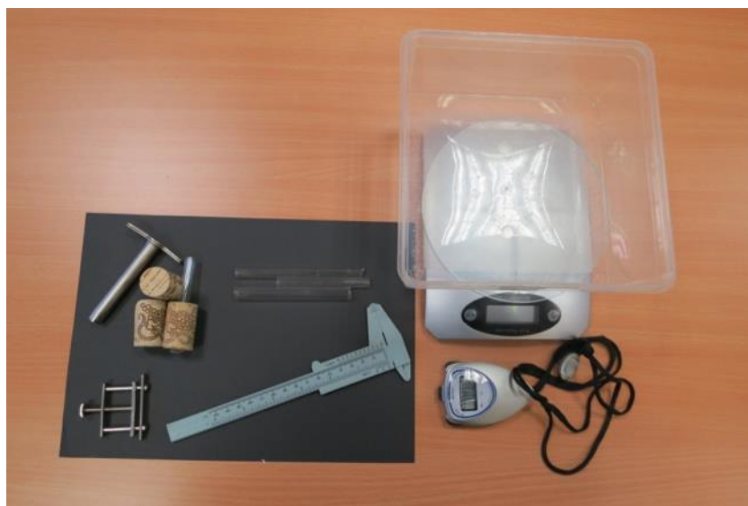
Slika 2.4. Pribor potreban za mjerenje protoka – digitalna vaga, posuda, zaporni sat, cjevčice različitih promjera, bušaći za čepove i čepovi, Hoffmannove stezaljke, pomična mjerka
