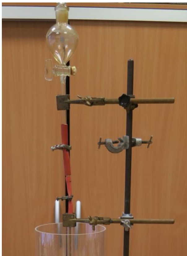
Slika 2.2. Lijevak s bojom spojen na gumenu cijev s dvije Hoffmannove stezaljke.
