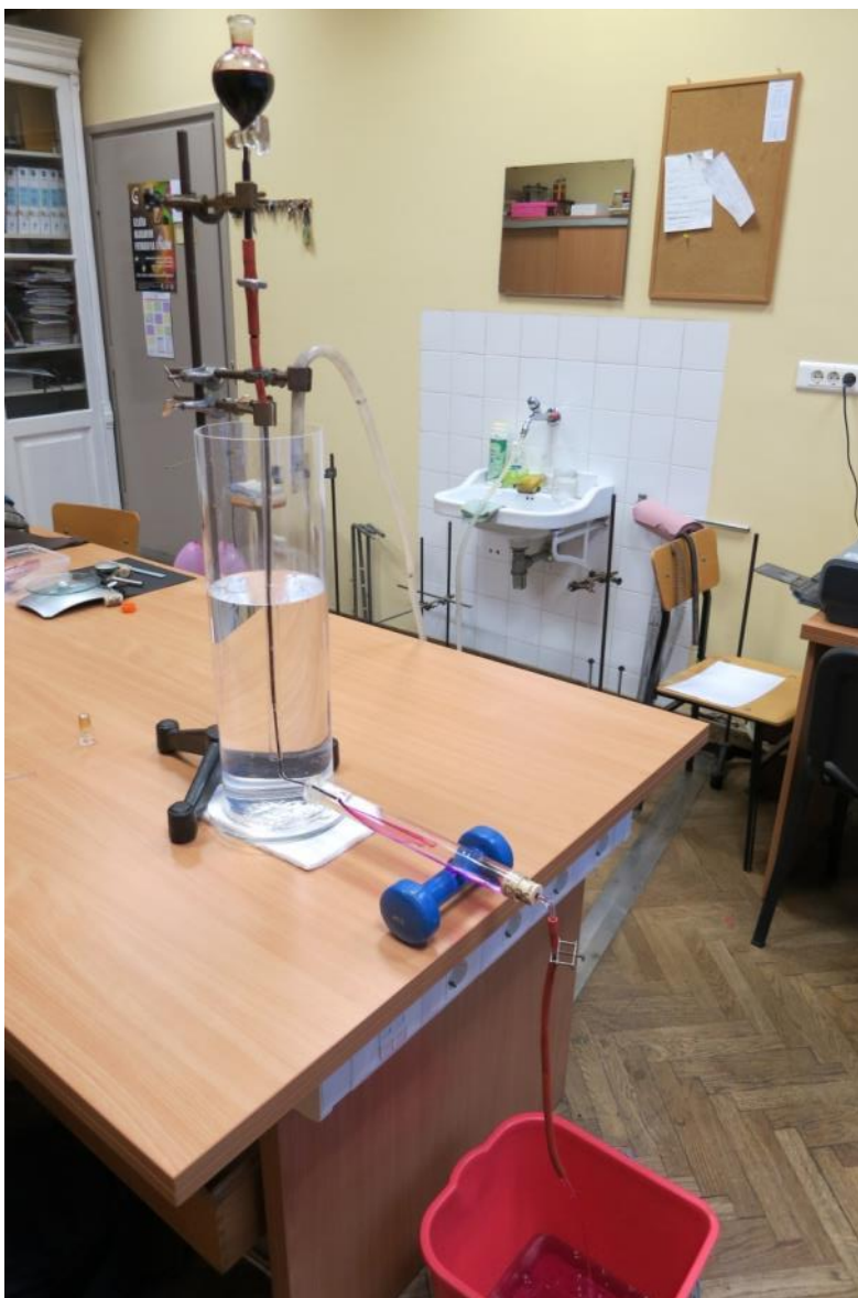
Slika 2.3. Sustav za mjerenje ispunjen tekućinom – otvaranjem stezaljki i ventila na vodovodu počinje strujanje fluida
