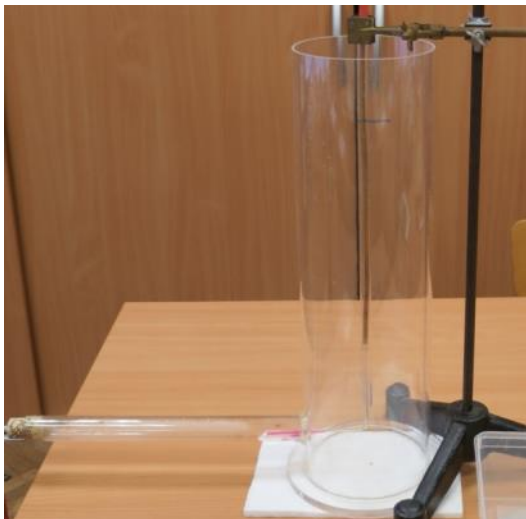
Slika 2.1. Dijelovi aparature postavljene za mjerenje brzine protoka fluida i promatranje strujanja
