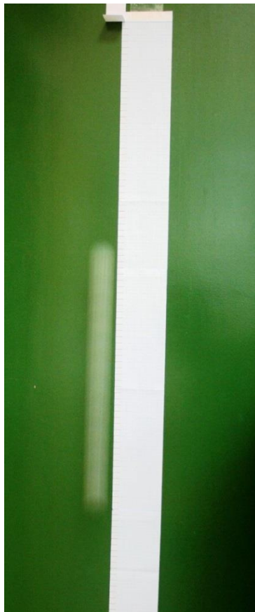
Slika 2. Fotografija slobodnog pada loptice uz ekspoziciju 1/8 s
