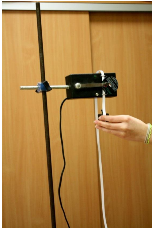
Slika 3. Elektromagnetsko tipkalo bilježi slobodni pad tijela
